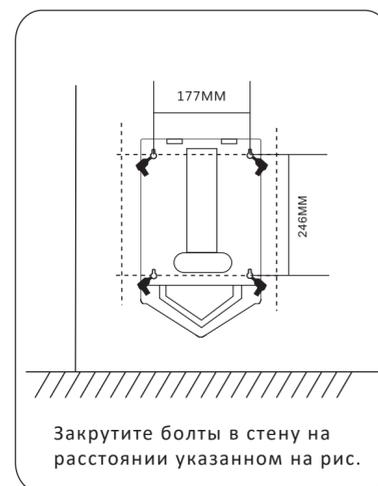
Закрутите болты в стену на расстоянии указанном на рис.
